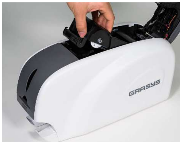
図 17 リボンカートリッジをプリンターに装填
